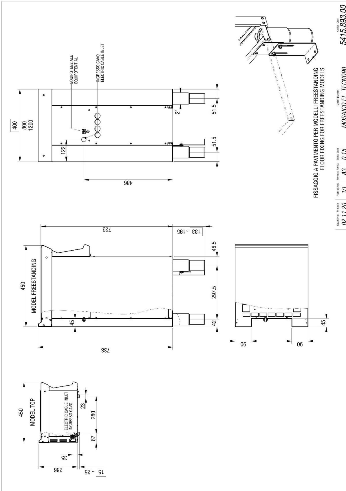
FISSAGGIO A PAVIMENTO PER MODELLI FREESTANDING
